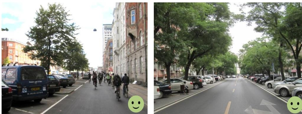
图 12.3.4 路侧停车泊位结合机非隔离带布置正例
