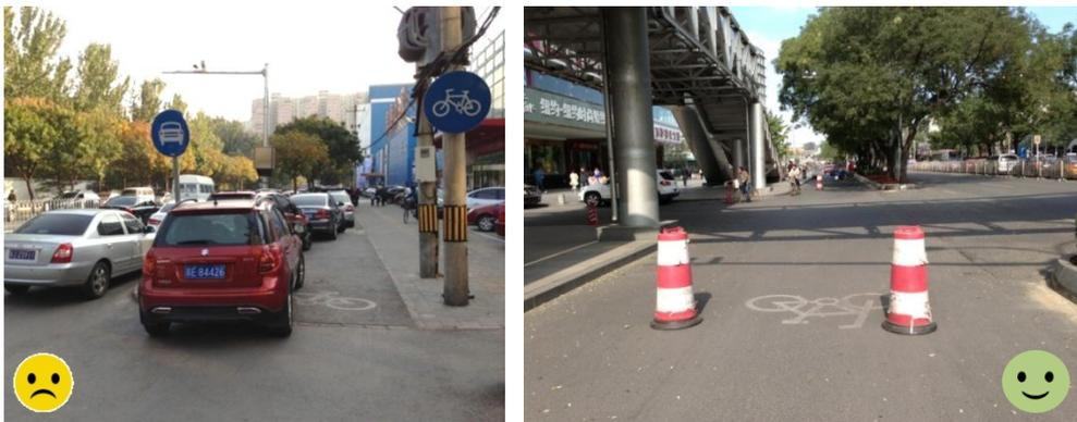
图 8.2.3 自行车道入口处设置阻车桩反例和正例
