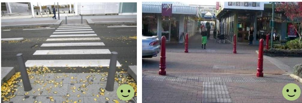
图 5.4.3 人行横道阻车桩设置正例
