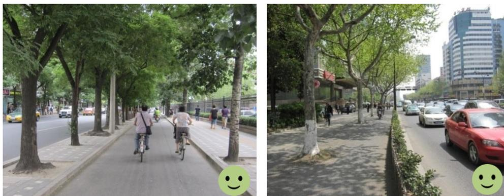
图 8.2.1 - 1 自行车道采用机非物理隔离正例
