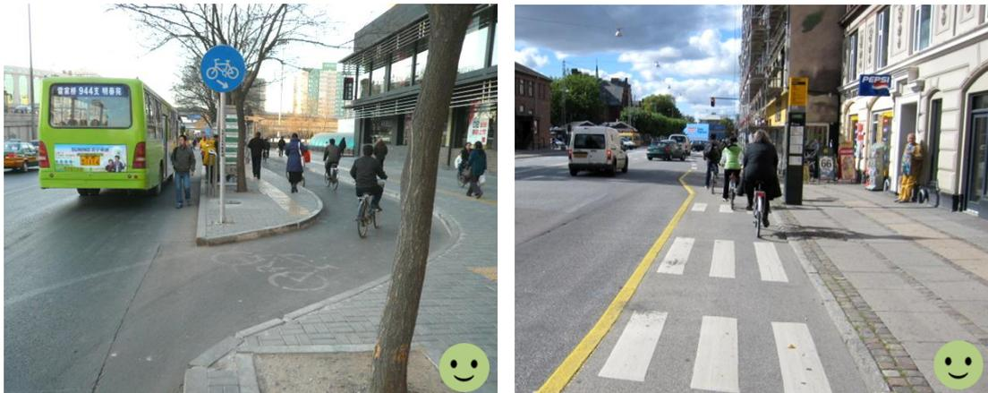
图 11.2.5 自行车道与公交站结合正例（左，有机非分隔带；右，无机非分隔带）
