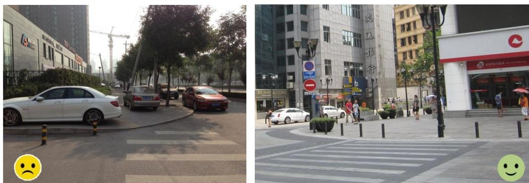
图 5.5.2 交叉口转角设置阻车桩反例与正例
