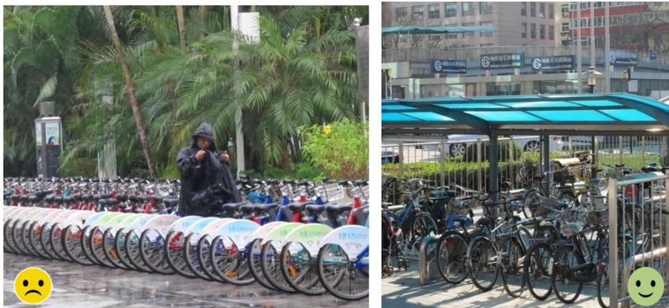
图 9.3.4 自行车停车场设置雨棚反例与正例
